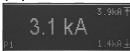
Abb.4: Anzeige des aktuellen Werts mit der aktivierten Funktion der Messung des Stroms
