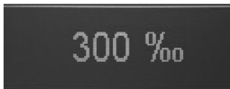
Fig.5: affichage de la valeur de consigne du courant avec la fonction de la mesure du courant désactivée
