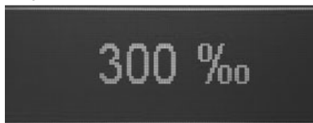
Fig.5: visualización del setpoint de corriente con la función de medición de corriente desactivada
