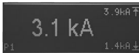
Fig.4: affichage de la valeur réelle avec la fonction de la mesure du courant activée
