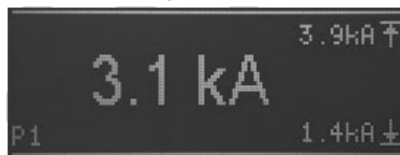
Fig.4: visning av det aktuella värdet med aktiverad strömmättningsfunktion
