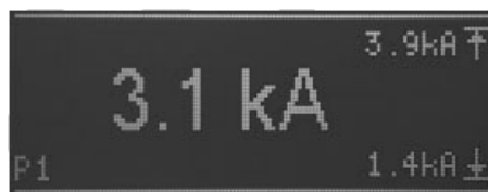
Fig.4: weergave van de huidige waarde met de stroom-meetfunctie ingeschakeld
