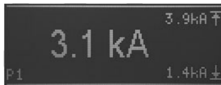
Fig.4: visualización del valor actual con la función de medición de corriente activada
