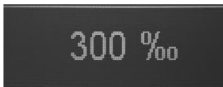
Fig.5: visning av strömmens setpoint med avaktiverad strömmättningsfunktion
